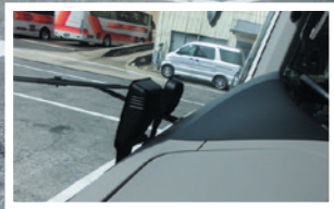
フロントウインドウの車内側には、衝突軽減システムに使用するカメラが設置されています。
