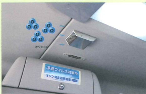
オゾン発生装置
